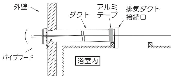
ダクトは必ず屋外側に下り勾配(1/100~1/50)を設けてください。雨水の浸入や結露水の逆流の原因になります。
