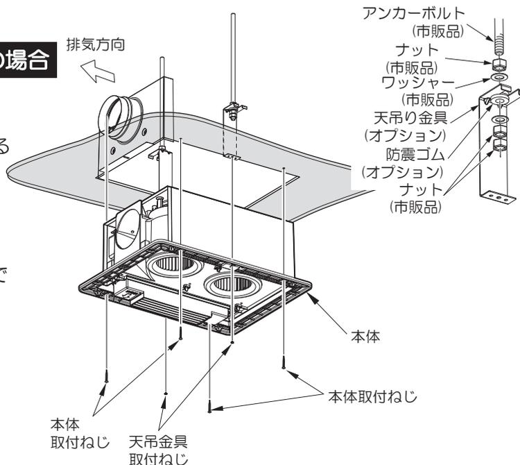
●アンカーボルトの取付寸法についてはP8「1.取り付け前の準備」を参照してください。
