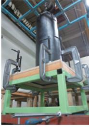
15万回の65kgサンドバッグ落下試験(自社規格)をクリアしています。
