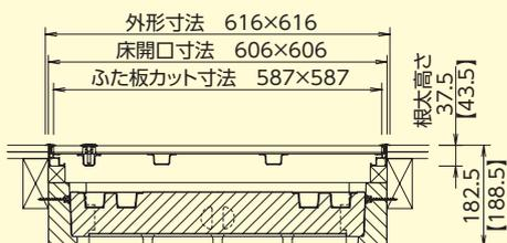
14 断熱床下点検口450型
