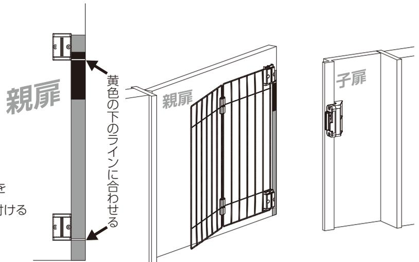
③本体にフックを取付けて、ガタツキなく取付けできているか確認する。
