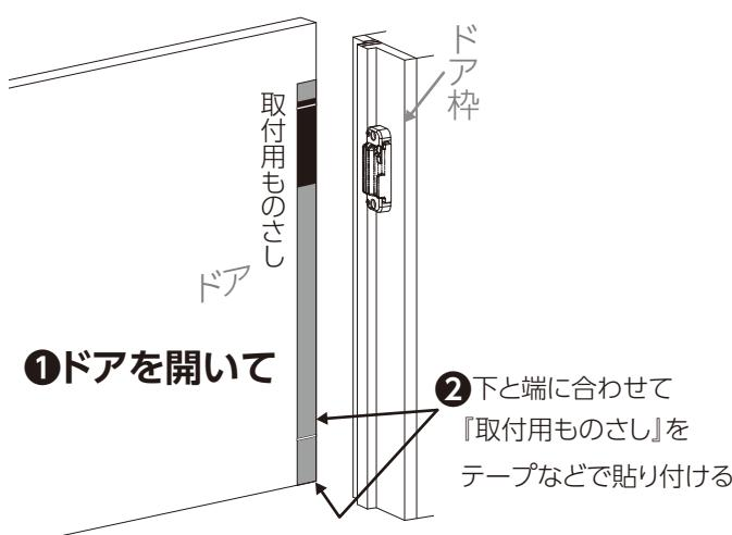
2.『取付用ものさし』の黄色線にドア台座の下部を合わせ、両面テープで取付けます。
