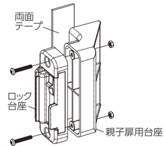
2. 『取付用ものさし』の目印に合わせ、子扉にロック台座を取付けます。
