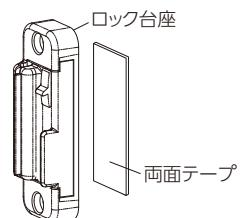
2.『取付用ものさし』を使用して、ドア枠にロック台座の目印に合わせ、ロック台座を取り付けます。
