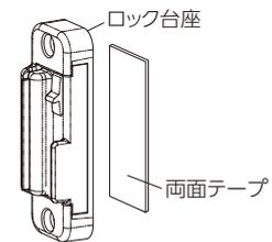
2. 『取付用ものさし』を使用して、ドア枠にロック台座の目印に合わせ、ロック台座を取付けます。
